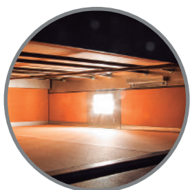
Cámara, ladrillos refractarios
